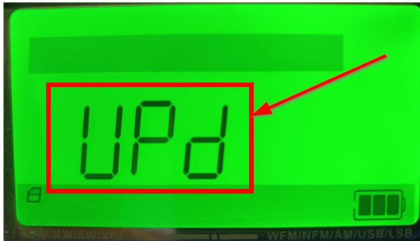
**ACHTUNG:** Entfernen Sie unter keinen Umständen die microSD-Speicherkarte aus dem **RADDY** RF919 und trennen Sie das Radio während der Aktualisierung nicht von der externen Stromversorgung. Drücken Sie auch keine Tasten am Radio. Der Aktualisierungsvorgang dauert etwa 10 Sekunden.
