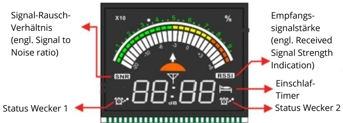
Die meisten Arbeitsparameter werden auf der primären Anzeige ausgegeben. Einige Parameter werden jedoch auf der sekundären Anzeige ausgegeben. Dies sind:
