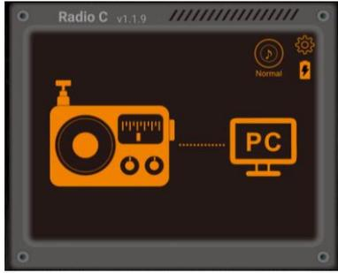
Wenn das Radio über USB mit einem PC verbunden ist, kann der PC-Modus ausgewählt werden. Wenn der PC-Modus ausgewählt ist und eine TF Speicherkarte in den TF Speicherkartenschlitz auf der rechten Seite des Radios eingelegt wurde, wird der Inhalt der eingelegten TF Speicherkarte auf dem PC als separates Laufwerk angezeigt. Dadurch ist es einfach möglich, Musikdateien auf der TF Speicherkarte zu hinterlegen, ohne hierzu die TF Speicherkarte aus dem Radio entfernen zu müssen.
