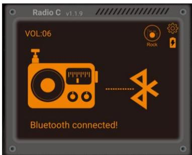
Um den Bluetooth-Audiomodus nutzen zu können, muss ein Bluetooth-fähiges Audio-Streaming-Gerät über Bluetooth mit dem Radio verbunden sein. Sobald die Verbindung hergestellt ist (Meldung "Bluetooth connected!"), können Sie die normalen Navigationstasten Ihres Mobilgeräts und die Navigationstasten [▶], [⏸] und [⏹] am Radio zur Steuerung der Audiowiedergabe verwenden.
